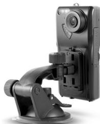
Приложите крепление опорной поверхностью к лобовому стеклу и зафиксируйте, нажав рычаг вакуумного механизма.
