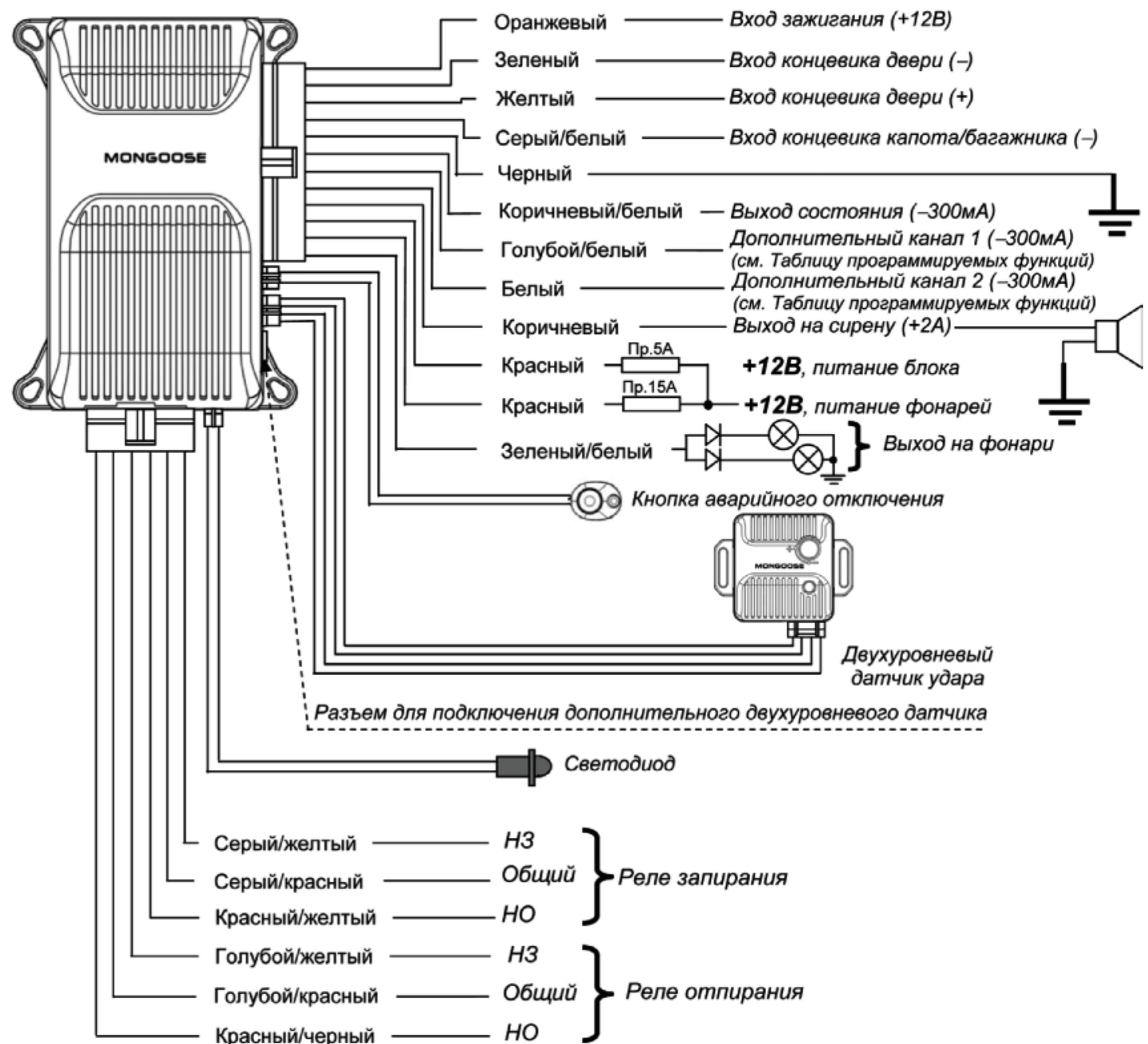
**Назначение проводов и разъемов центрального блока.**
