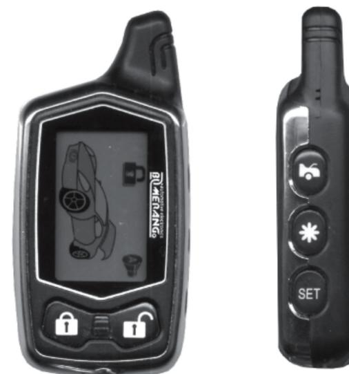
При нажатии кнопки пульта на дисплее будет мигать индикатор передачи (📡) (кроме кнопки **SET**). В случае приема пультом сигнала тревоги, на ЖК-дисплее появится символ нарушенной зоны охраны, включится звуковой сигнал и/или вибровзвон.
