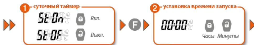
Режим позволяет запускать двигатель по выставленному суточному времени и будет действовать, если в установках брелока (меню «START») режим будет включен и установлено время запуска.
