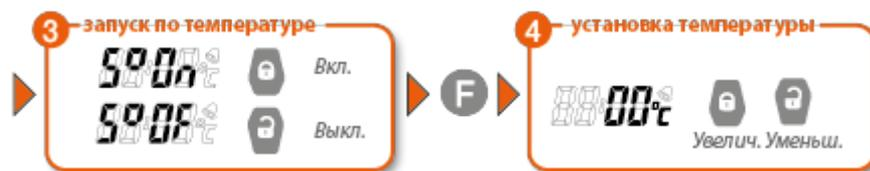
Режим позволяет автоматически запускать двигатель по его температуре и будет действовать, если в установках брелока (меню «START») режим будет включен и выставлена температура запуска.
