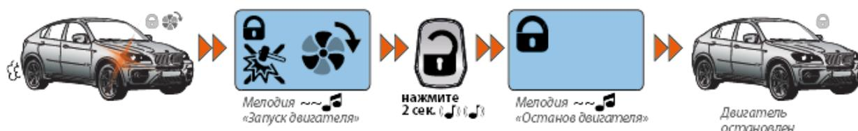
За одну минуту до штатной остановки двигателя на брелок придет оповещение об этом событии. На брелоке замигает пиктограмма
