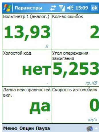
На экране отображаются параметры состояния автомобиля: контроль расходов топлива, скорости, диагностика двигателя, состояние датчиков и др.
