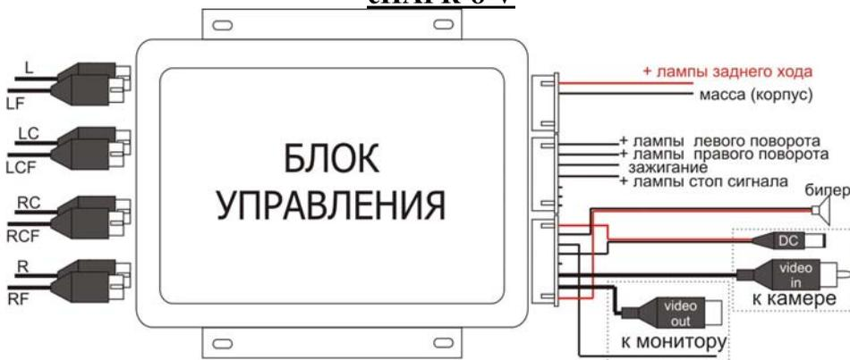
Если маркировка L, LC, RC, R, LF, LCF, RCF, RF отсутствует на датчиках, то подключайте их в любом порядке. При этом датчики с короткими кабелями устанавливаются в задний бампер, с длинными – в передний.
