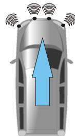
3. «**режим STOP**»: активируется при нажатии на педаль тормоза с задержкой в 1сек и работает до её отпускания. В режиме «**STOP**» работают все датчики сзади и (в сПАРК-6(8)-V) спереди.
