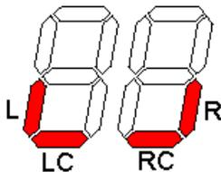
Сегмент(ы) соответствующие исправным датчикам горят постоянно, а сегмент(ы) соответствующие дефектным датчикам мигают в течение 3-х секунд в такт с предупреждающим звуковым сигналом.
